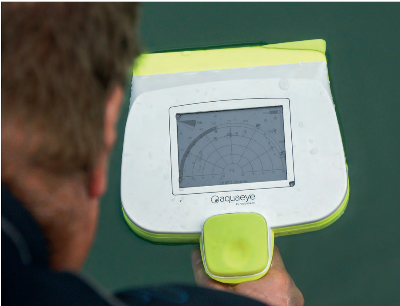
Das Handsonar »AquaEye« der kanadischen Firma »VodaSafe« ist einfach zu bedienen und stellt eine sinnvolle Unterstützung bei Einsatzlagen mit Personensuche im Wasser dar. Der Landesverband Nordrhein stellt das Testgerät auch Gliederungen zur Verfügung. © Jörg Dittmar
