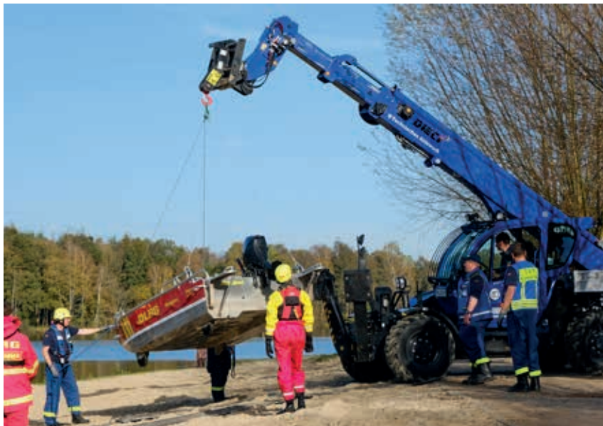
Mittels eines Bergungsräumgerätes wurden die Rettungsboote zu Wasser gelassen. Auch diese Option bedarf Übung, da im Einsatzfall nicht immer die optimalen Bedingungen zum Slippen gegeben sind.
