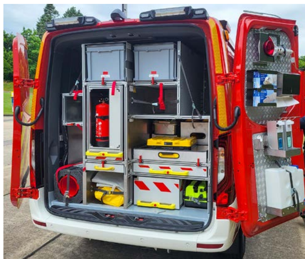
Blick in den Geräteraum des CBRN-Erkunders.
