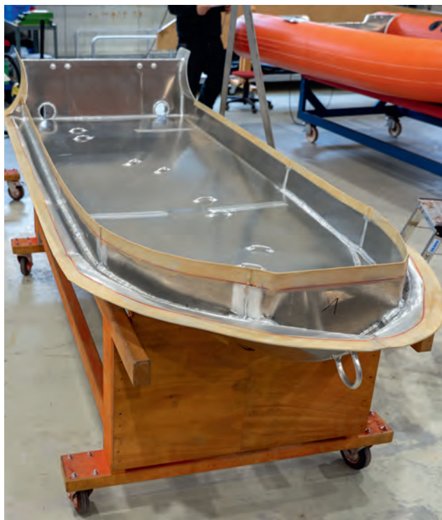
Vor der Verklebung mit dem Schlauchkörper wird der Rumpf an den Klebestellen entsprechend vorbereitet, damit später auch alles sicher hält.
